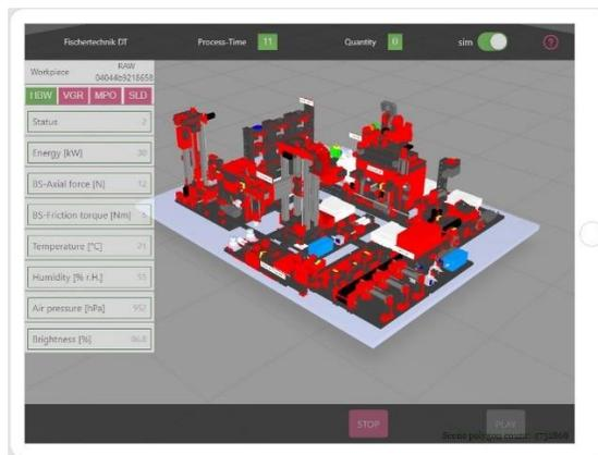
Abb. 3: Digital Twin der Lernfabrik mit Benutzeroberfläche
