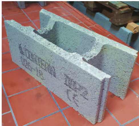
FIG. 2 Masonry block (Gelen Gaël Chewe Ngapeya & Waldmann, 2020)
